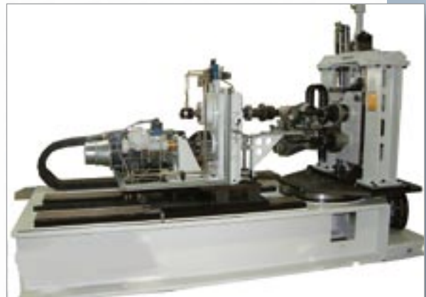
Seitenwellenprüfstand, hydraulische Verspannleistung 400 kW
