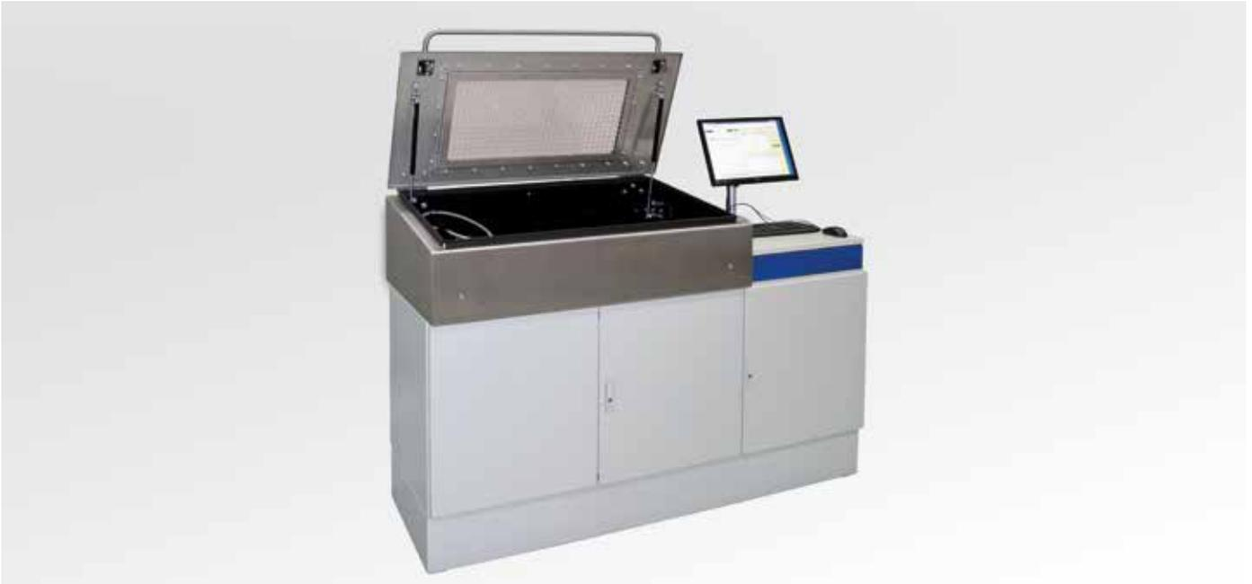
Der Prüfstand ist konzeptioniert für Berstprüfung von Hydraulikschläuchen oder Rohrstücken mit einem max. Druck von 3000 bar. Die wesentlichen Bestandteile des Prüfstandes sind eine Prüfkammer mit Polycarbonatfenster im Deckel, Befülleinrichtung für die Prüflinge, pneumatische Pumpe für Druckerzeugung und ein Regelsystem zur Steuerung des Prüfstandes.
