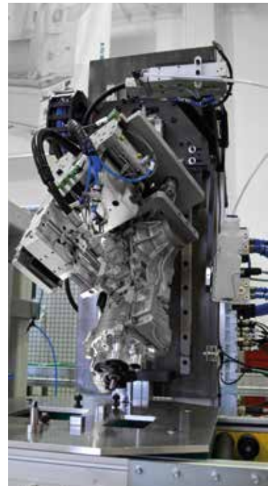
Ölbefüllung in optimaler Befülllage
