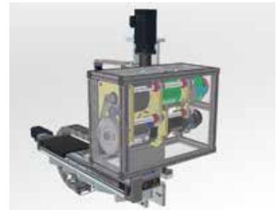
Optional: Schaltroboter mit Zustelleinrichtung
