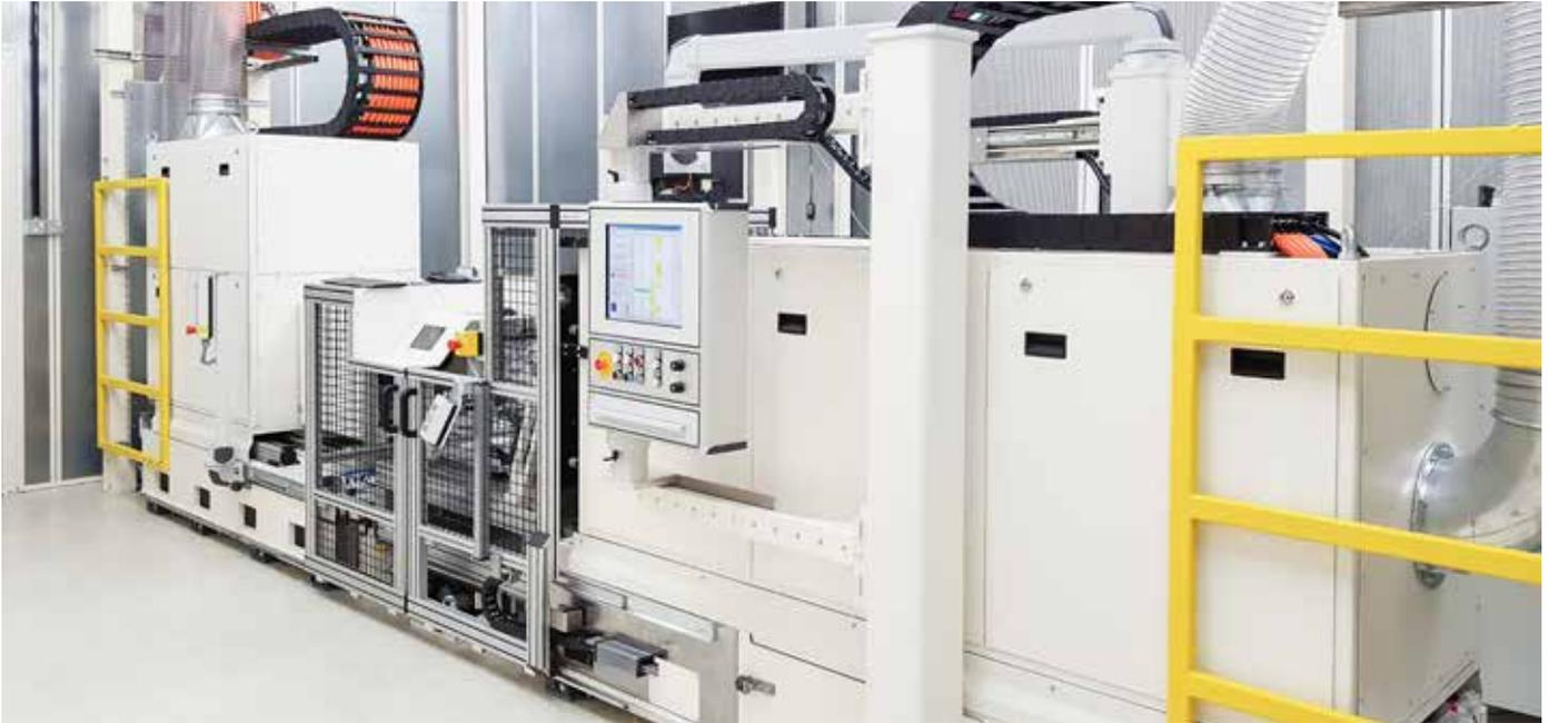
Die von Blum-Novotest entwickelten Getriebe-Prüfstände dienen der produktionsbegleitenden Qualitätssicherung. Mit diesem hier dargestellten Prüfstand wird am Ende der Linie die Funktion des Getriebes getestet. Es handelt sich hierbei um eine 100 % Prüfung.
