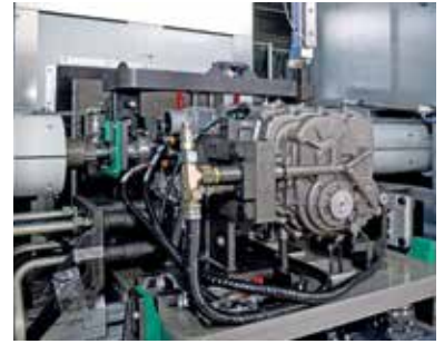
齿轮组供油循环系统
