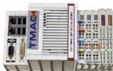
TMAC IPC は、パワートランスデューサーからの負荷データを解析し、CNC及びPCとの通信を行います。
