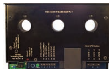
TMACパワートランスデューサーが主軸モーターの負荷をモニターします。
