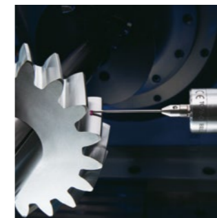
Detección de errores de mecanizado en máquinas rectificadoras de engranajes
