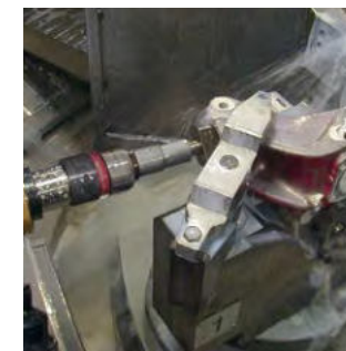
Messung einer Achsschenkelbohrung vor dem Schlitzen
