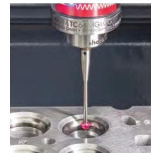
Analoger Konturscan der Dichtfase an einem Ventilsitz
