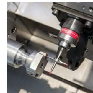
Werkstückmessung in der Drehmaschine
