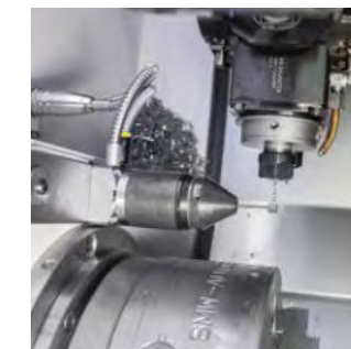
Werkzeugmessung – TC76 mit Schutzhülse
