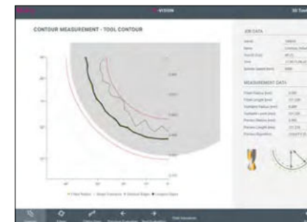
Visualisierung der Messergebnisse eines Kugelfräasers
