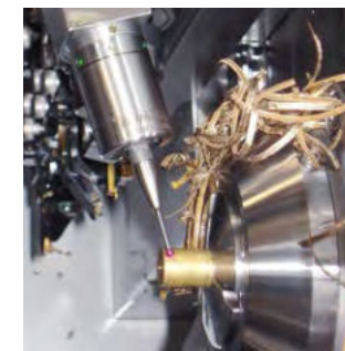
Werkstückmessung in der Drehmaschine
