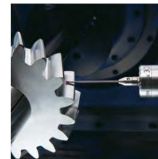
Erkennen von Bearbeitungsfehlern auf Zahnradschleifmaschine
