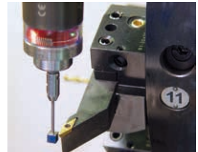
旋盤でのツールセッティング
