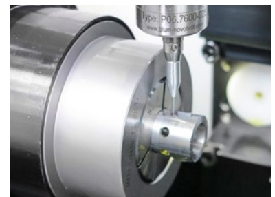
Enregistrement analogique dans un trou oblong conique
