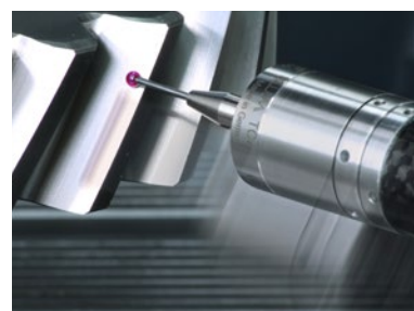
Detekce chyb obrábění na brusce ozubení
