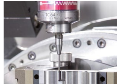
TC64-RG – Misurazione della rugosità superficiale nel centro di lavorazione
