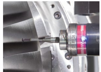
Misurazione della rugosità integrata nel processo su un blisk
